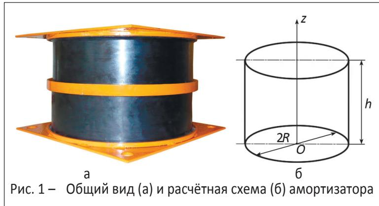
Рис. 1 – Общий вид (а) и расчётная схема (б) амортизатора
